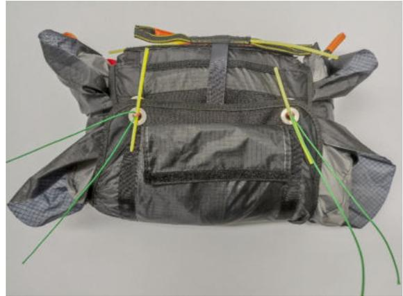
Der Container ist jetzt provisorisch verschlossen. Entferne die Hilfspins und ersetze diese durch die Pins des Auslösegriffs. Stecke die Enden von den Pins und die Enden des Auslösegriffs in die dafür vorgesehenen Taschen. Entferne die Hilfsleine vorsichtig.
