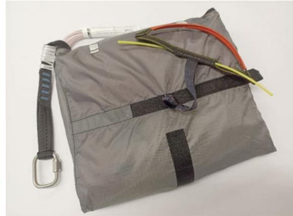
Verbinde beide Enden der V-Leine mit Hilfe von C6 Quicklinks (Rechteckkarabinern) mit der Verbindungsleine vom Rettungsgerät. Den Quicklink mit Hilfe eines Maulschlüssels sorgfältig verschließen. Die V-Leine sollte mit den mitgelieferten O-Ringen in der Mitte des Quicklinks fixiert werden.
