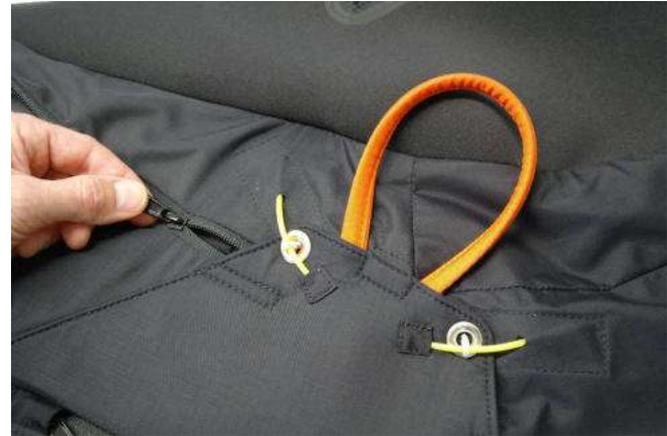
Schließe den V-Leinentunnel, indem du den Reißverschluß zum oberen Teil des Gurtzeuges hin bewegst.
