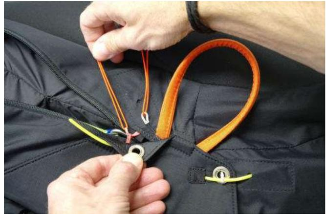
Stecke mit einer Hilfsleine die weiße Schlaufe durch die obere rote Schlaufe, wie gezeigt.
