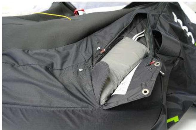
Das Gurtzeug ist mit einem Stift ausgestattet, um den leeren Teil des Containers zu schließen. SchlieÙe den Container wie oben beschrieben.
