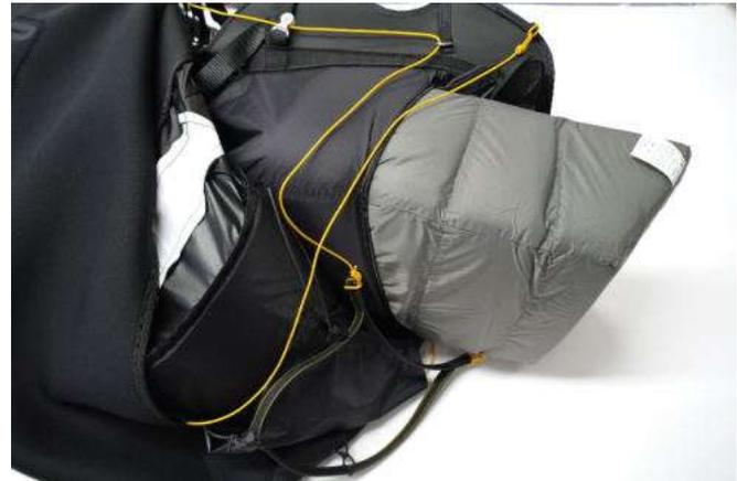
Das Luftschaumpolster füllt den Raum zwischen dem Rücken des Piloten und dem Rettungsschirmcontainer aus. Es verbessert den Sitzkomfort und bietet gleichzeitig einen zusätzlichen Schutz. Es wird mit einem Klettverschluss befestigt.
