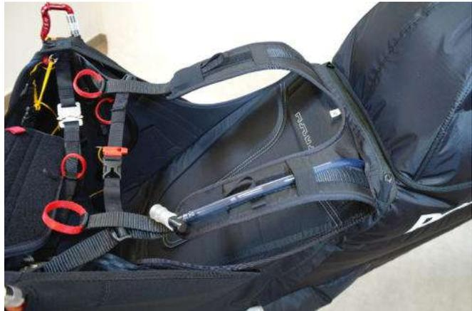
Unter dem vorderen Teil der Sitzplatte befindet sich ein kleines Ballastfach (ca. 4l). Natürlich kann es auch für alles andere verwendet werden.
