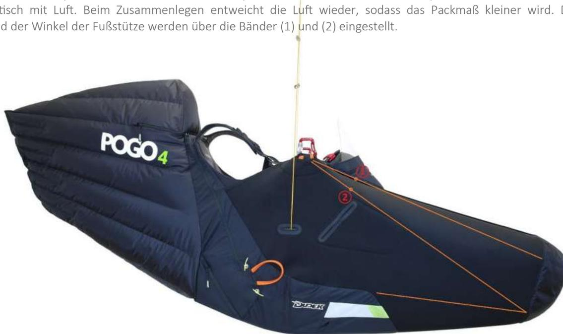
Die Länge der linken oberen Leine kann nach vorherigem Spannen der rechten Seite des Beinsacks angepasst werden. Dies kann durch Bewegen des roten Balls #3 erfolgen, bis die gewünschte Einstellung erreicht ist. Die rechte Seite des Beinsacks wird geschlossen, indem die Kugel #4 und #5 in die Schlaufen des Sicherheitsbandes #6 eingeführt wird. Die linke Seite wird durch die Schnalle #7 geschlossen und eingestellt. Dieser Teil des Beinsackes ist Teil des Cockpits
