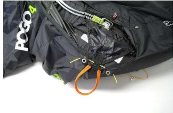
Führe die Schlaufe mit Hilfe der Hilfsleine durch die Metallöse und blockiere sie mit einem Stift.
